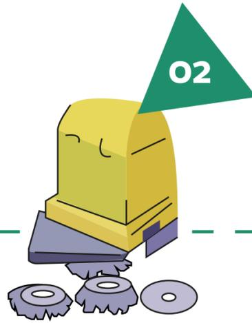
Controllare lo stato della macchina e montare le spazzole. Riempire il serbatoio con la soluzione del prodotto detergente
