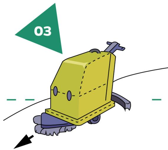
Abbassare le spazzole ed il succhiatore e iniziare l'operazione di lavaggio del pavimento
