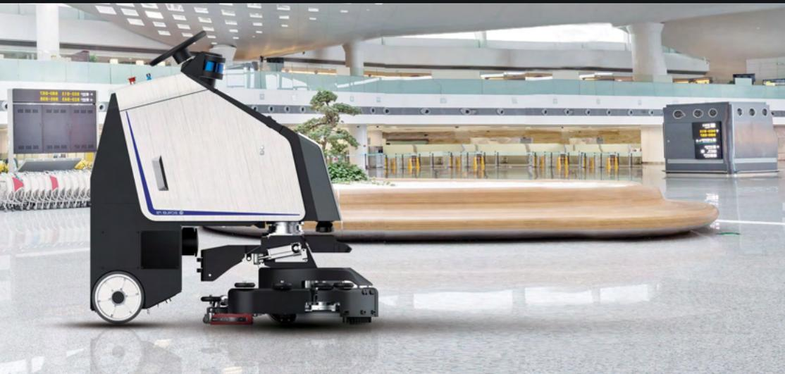
Realizzato per la pulizia di grandi spazi **Scrubber 75** è il robot lavapavimenti autonomo con una produttività teorica fino a **3000 mq/h.** e con un'autonomia operativa in continuo da **4** e fino a **6h.** ideale per il lavaggio giorno e notte in centri commerciali, GDO, parking, logistiche, aeroporti, stazioni, comunità e siti di produzione e manifattura industriale.
