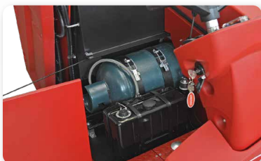
Impianto GPL LPG system Instalación de GLP
