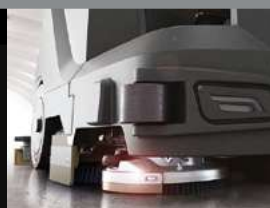
La terza spazzola laterale aumenta le performance di pulito lungo le pareti (disponibile nelle versioni MMg a disco)
