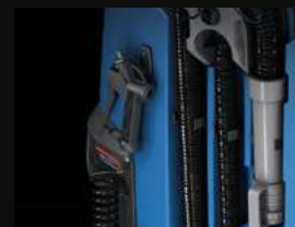
Pistola igienizzante per sanificare la macchina al termine del turno (disponibile solo con il Disinfector)
