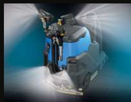
Il Disinfector si compone di due gruppi di ugelli posizionati sopra al serbatoio per l'igienizzazione delle superfici verticali e di un gruppo alla base della macchina destinato al pavimento
