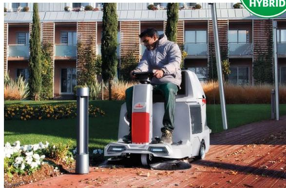
CS60 Hybrid lavora fino a 7,5 ore senza mai fermarsi. Mentre la spazzatrice utilizza il motore a benzina, le batterie si ricaricano: in questo modo si può passare dall'alimentazione a benzina a quella elettrica per lavorare in modo silenzioso, ecologico ed economico.
