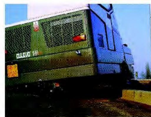
Trasmissione diretta con motoruota
