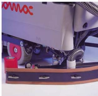
Il gruppo tergipavimento, robusto e dotato di efficaci rulli paracolpi, è stato studiato per asciugare perfettamente con qualsiasi stile di condotta della macchina, anche con curve molto strette. La regolazione del tergipavimento viene eseguita senza utensili direttamente dall'operatore
