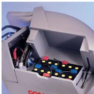
Sollevando il serbatoio di recupero, perfettamente equilibrato grazie ad una molla a gas, si accede alla zona batterie, all'impianto elettrico e a quello di aspirazione. Il vano batterie è stato progettato per ospitare sia batterie modulari che cassoncini con capacità fino a 240 Ah
