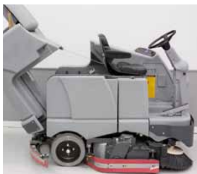
Il serbatoio di recupero può essere inclinato per una pulizia più agevole e per accedere facilmente al vano batterie
