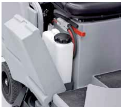
Il sistema Ecoflex™ si caratterizza per il facile accesso alla tanica del detergente
