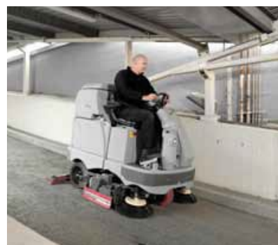
Il potente motore di trazione consente di salire facilmente su rampe e superare pendenze fino al 16%
