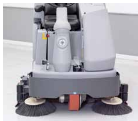
Spazzole laterali retrattili sul modello cilindrico per convogliare i detriti al centro della macchina
