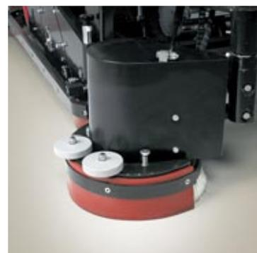
La macchina è dotata di una spazzola laterale estraibile che convoglia lo sporco solido verso le spazzole cilindriche. In presenza di spigoli ed irregolarità del muro essa si autoregola in modo automatico grazie ad un apposito snodo
