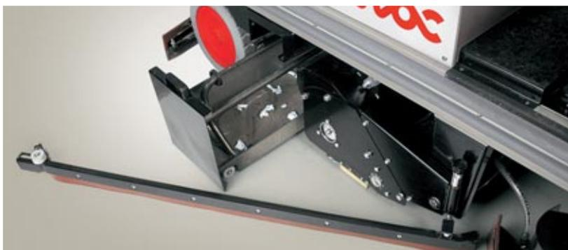
Il cassetto di raccolta dello sporco solido è di facile estraibilità senza ausilio di utensili per poter essere comodamente svuotato
