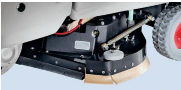
Il gruppo lavante dotato di due spazzole a disco con una pressione fino a 50 kg, risulta ora più potente grazie al nuovo motore da 1250 W. Il sistema di sollevamento del basamento è stato migliorato con l'introduzione di due bracci di acciaio indipendenti che ne consentono un perfetto adattamento al pavimento
