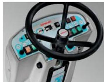
Sul cruscotto sono posti tutti i comandi principali, accessibili comodamente dall'operatore al posto di guida e di facile lettura. Lo sterzo morbido ed il raggio di curvatura di soli 2450 mm rendono la guida agile anche in spazi ristretti come corsie, corridoi o linee di produzione. In Tripla 85 c'è anche la possibilità di regolare l'inclinazione del blocco sterzo, adattabile ad ogni utilizzatore
