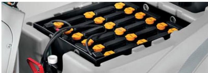
Il vano batteria è facilmente accessibile alzando la parte superiore della macchina facendo presa sotto il sedile. L'apertura a 90° consente il comodo alloggiamento sia di batterie singole che di cassone a 36 Volt
