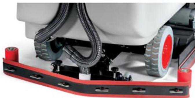
Il tergapavimento segue perfettamente i movimenti della macchina permettendo così un'ottima asciugatura, senza lasciare tracce. L'operatore può regolare facilmente l'inclinazione del tergapavimento agendo semplicemente su due pomelli a vite. Le gomme possono essere utilizzate 4 volte, una per filo, e sono smontabili tramite degli agganci studiati appositamente per una facile sostituzione senza utensili.
