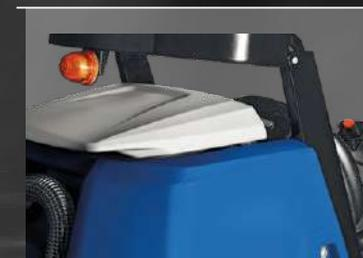
▲ Rollbar ripiegabile con luce lampeggiante
