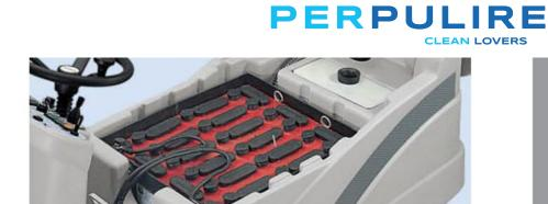
Il vano batterie, che può ospitare un cassone da 36 Volt, è ampio e di facile accesso grazie all'apertura totale del serbatoio soluzione. Il serbatoio di recupero, che avvolge le batterie, si pulisce attraverso il coperchio dell'aspirazione. Il motorino di aspirazione, per questioni di sicurezza, entra in funzione solo quando il serbatoio soluzione è abbassato
