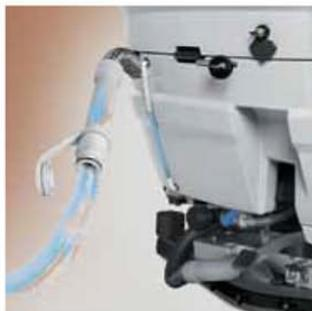
Il particolare design conferito al serbatoio di recupero e il tubo di scarico di grande diametro consente di svuotare completamente l'acqua sporca raccolta senza lasciare alcun tipo di residuo **IN TEMPI MOLTO RAPIDI**
