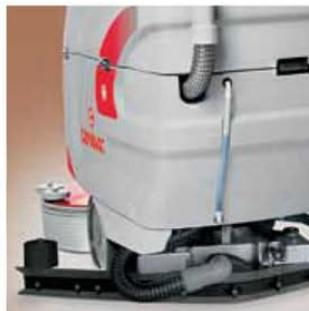
Un comodo tubicino installato nella parte posteriore consente di tenere sempre sotto controllo il livello dell'acqua pulita presente nel serbatoio
