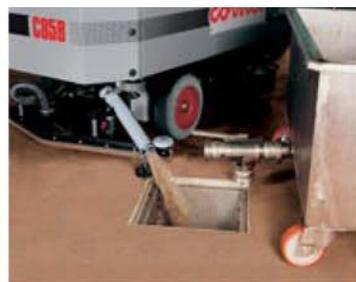
Lo scarico del serbatoio di recupero è nella parte inferiore destra posteriore della lavasciuga, in maniera da renderne molto agevole lo svuotamento. Togliendo il tappo, in meno di tre minuti il serbatoio è vuoto, pronto per un altro ciclo di lavoro
