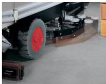
Il gruppo lavante è dotato di due spazzole controrotanti e può traslare lateralmente per facilitare la pulizia lungo muri e scaffali. In caso di urto laterale il basamento rientra automaticamente senza la necessità di alcun comando (è in grado di assorbire gli urti)
